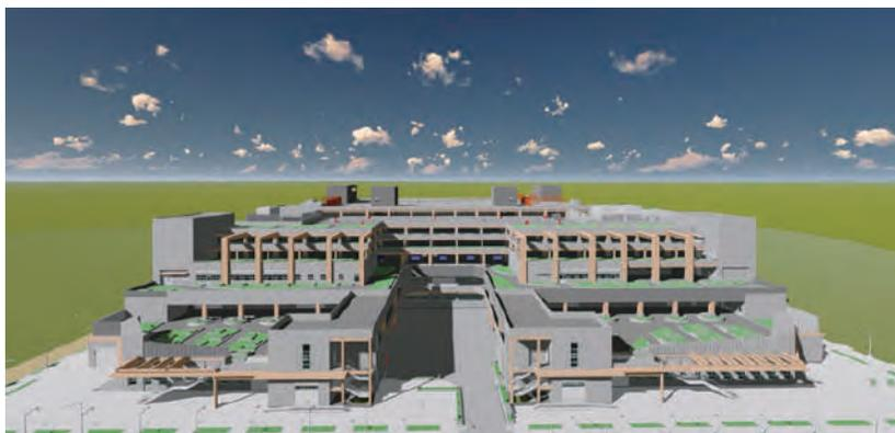
(2) 干涉檢察：確認現地施工前各系統結合後之可行性，例如結構與機電系統，3D模型較2D更易於理解，可以加速施工議題之溝通效率。
